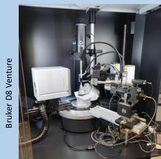
Détecteur de rayons X de haute qualité pour des mesures à haute résolution
